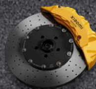
Карбон керамична спирачна система
